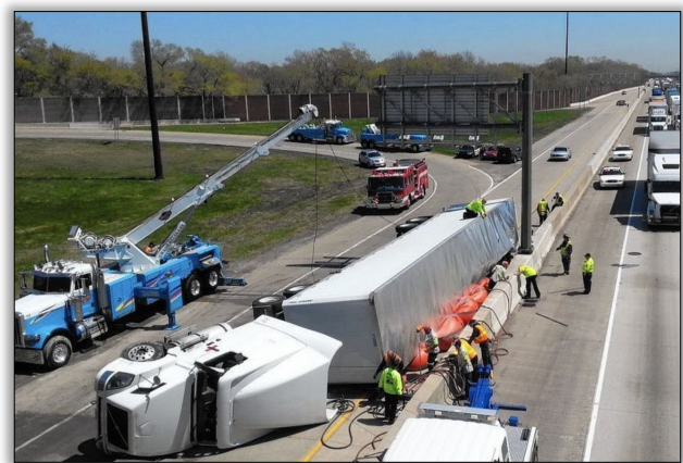
Despacho de Grúas en Evento de Evacuación
